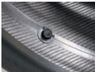
タイヤ内側に取り付けられたセンサー
