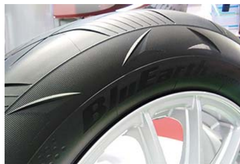
サイドウォールにフィン状突起を配し、 空気の流れを制御
