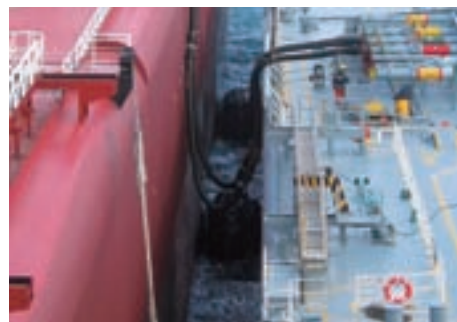
「2船体操船および係留監視システム」は、船舶間に置かれた空気式防舷材の空気圧を遠隔監視することで、接触事故などを防止します
