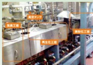
三重工場の再生処理設備（二軸スクルー押出機）
